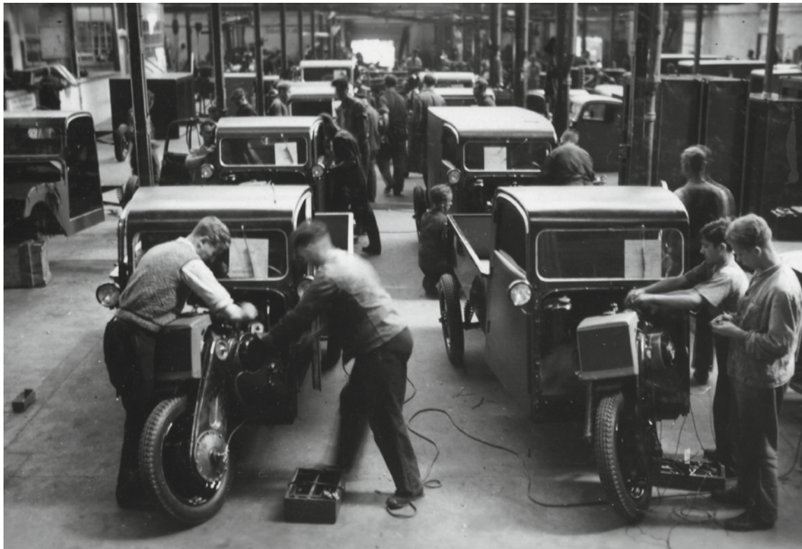
1935–1938: Tempo-Front als Rohbauten, bei der Serien-Montage in der Montagehalle. In zwei Reihen stehen die Tempo-Fronten während sie Stück für Stück montiert werden. Das Foto des Werksfotografen zeigt eine erste Form von Fließarbeit, die Reihen- oder Serienmontage.
