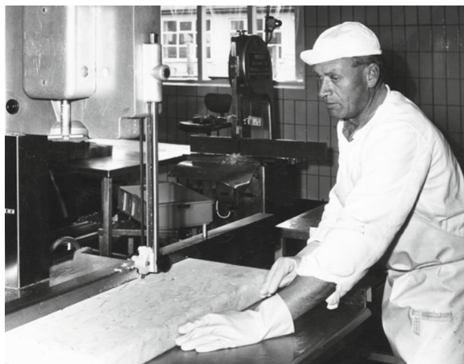
An der Säge werden die Filetblöcke in handliche Portionen geschnitten, zum Beispiel für Fischfilet oder Fischstäbchen. Unilever, 1968 (Foto: Johannes Fleck)
