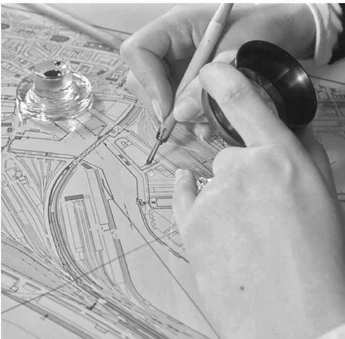
Zeichnen von Linien mit der Feder
