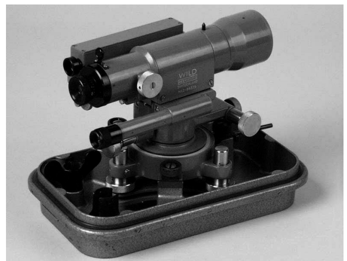
Nivelliergerät zur Gelände Vermessung (1970–1980) (Foto Karin Plessing)
