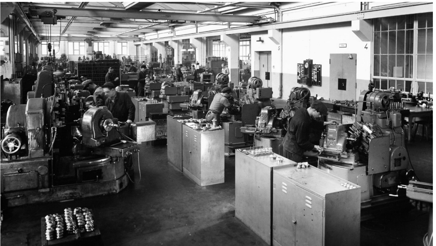
Herstellung von Kleinteilen an Dreh- und Fräsmaschinen für die Drehbänke von Heidenreich & Harbeck, Wiesendamm 30 (Foto Ralph Kleinhempel, 1951–53)
